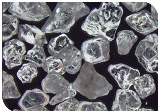
Abb. 2 - Zuckerkrystalle - Ansicht mit EVO Cam II (100-fache Vergrößerung)
