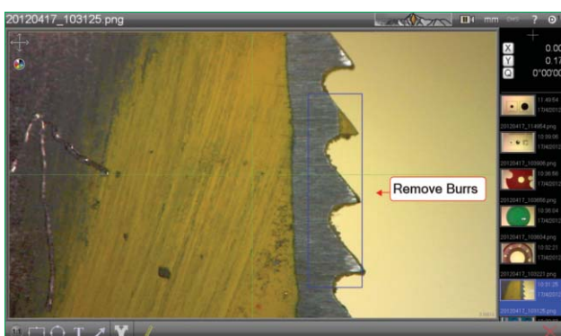
Detailaufnahme eines Sägeblattes mit Beschriftung bzgl. Gratentfernung.
